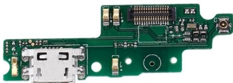
Placa de carga com USB para Redmi 4x
