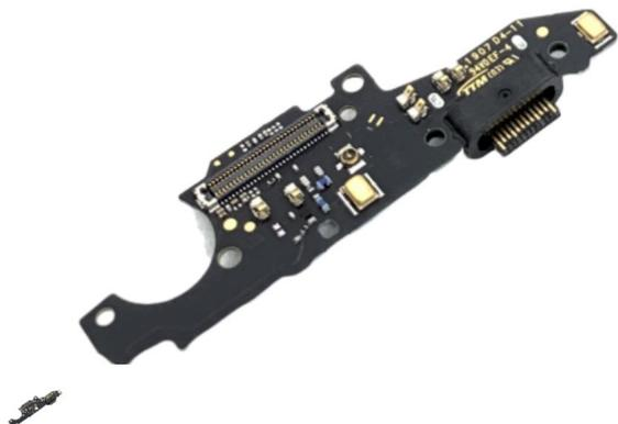
Módulo de carga para Huawei Mate 20 X
