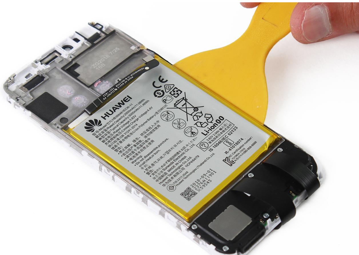
Huawei Y5p Substituição da Bateria
