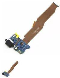
Flex com conector de carga e microfone para Xiaomi Mi5
