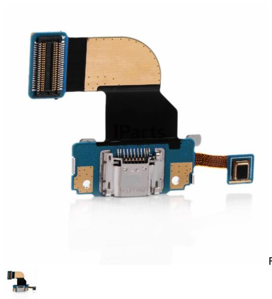
Flex com conector de acessórios e carga micro USB para Tablet Samsung T310
