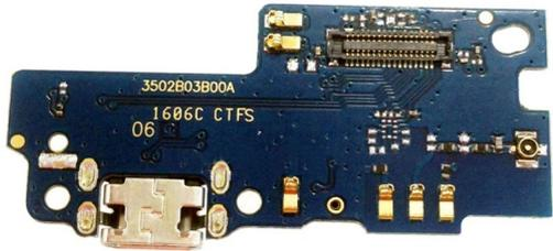
Conector micro USB e microfone para Xiaomi Mi Max
