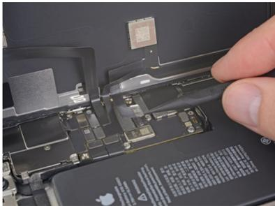
iPhone 11 Pro Max Substituição Módulo de carga
