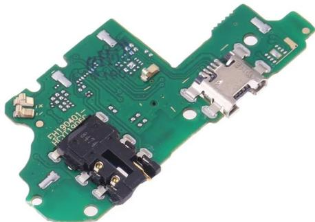
Huawei P Smart 2019 Substituição do Módulo de Carga
