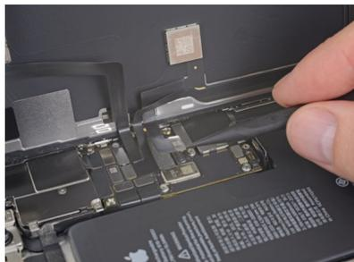
iPhone 11 Substituição Módulo de carga
