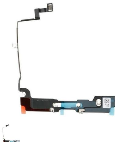
Antena de conexão para Iphone X
